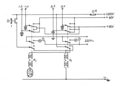
Abb. 42. Schaltung der Relais G1 und R1 vor Besetzung des Feldes 1 durch den Spieler bzw. den Roboter. Die Besetzung dieses Feldes wird den Spieler durch Aufleuchten der Lampen R1 oder G1 (Rot bzw. Grün) sichtbar gemacht; der Roboter wird hiervon durch das Potential der Anschlüsse g1a, g1b, r1a und r1b verabsichtigt.
