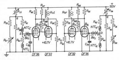
Abb. 25. Die beiden identischen Stufen für eine empfindliche Temperaturmessung an zwei Stellen. Der Einfluss der Umgebungstemperatur wird hierbei durch Serienschaltung der beiden gleichen N.T.C.-Widerstände kompensiert. Die Stufen, die als bistabile Multivibratoren ausgeführt sind und eine hohe Empfindlichkeit besitzen, werden durch eine örtliche Temperaturerhöhung des N.T.C.-Widerständes L für die eine bzw. des N.T.C.-Widerständes R für die andere Seite bedient.
