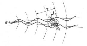
Abb. 10. Wie man die Richtung einer Schallquelle feststellen kann. Der Phasenunterschied infolge der verschiedenen Entfernung der beiden Ohren bis B ist mit t bezeichnet. T bedeutet die Schwingungszeit einer ganzen Periode der Schallschwingung.
