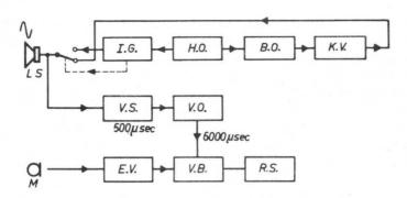
Abb. 26. Blockschema des akustischen Radarsystems
