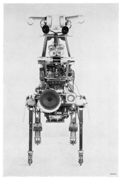
Vorderansicht. Die Aufnahme wurde noch vor dem Anbringen der Plastikhaut gemacht. Deutlich sichtbar sind die Ohren (Mikrophone), die Augen, (Photozellen), die Nasenlöcher (NTC-Widerstände). Die Zunge war noch nicht angebracht. Der Lautsprecher und das Mikrophon in der Mitte gehören zu dem Radarsystem.
