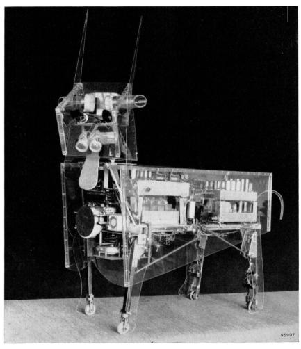
Im Kopf sieht man in der Reihenfolge von oben nach unten die beiden Ohren (Mikrophone), die beiden Augen (Photozellen), zwei Nasenlöcher (NTC-Widerstände) und die Zunge. Darunter ist in dem Rumpf der Lautsprecher und das Mikrophon des Radarsystems zu sehen.
