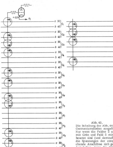
Die Schaltung der Abb. 44 mit Germaniumdioden ausgeführt. Nur wenn die Felder 2 und 8 mit Grün und Feld 5 mit Rot besetzt sind (und demzufolge die Spannungen der entspre-chende Anschlüsse sich geän-dert haben, kann die Gitterleitung der Torstufenröhre bezuglich 60 V positiv werden und einen Gegenzug auf
