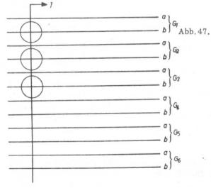
Abb. 47. Schaltung der Germaniumdioden für die Verlustmöglichkeit G1, G2, G3. Die Kreise stellen die Dioden dar. Diese sind wieder so angeschlossen, wie in Abb. 45 angegeben. Nur wenn an den Anschlüssen b von G1, G2 und G3 90 V liegen, wenn also die Felder 1, 2 und 3 durch Grun besetzt sind, kann an die Gitterleitung 1 eine Spannung von 90 V gelangen und die Tor-Stufenröhre B61 (Abb.43) einen Impuls durchgeben.
