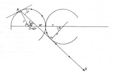
Abb. 33. Die Winkelbeziehungen müssen festgestellt werden, damit der Roboter sich bei einem bestimmten Winkel  $\gamma$  des Rumpfes R zur Richtung der Tonquelle G gewünschte Richtung steuert. Für einen Winkel  $\gamma$  zwischen 900 und 00 ist  $\gamma + \alpha$  annähernd konstant und etwa 2,5.
