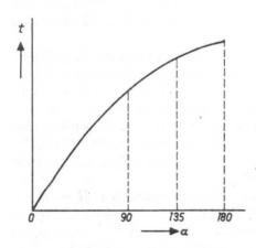
Abb. 21. Beziehung zwischen der Anzugszeit des Phasenindikators und dem Phasenwinkel. Erst über 135° beginnt Kurve zu stark von der Linearität abzuweichen.
