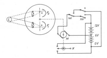
Abb. 9. Schaltung des Motors M durch die Relaiskontakte ssl und ssr. Aufstellung der Fotozellen F<sub>1</sub> und F<sub>2</sub> und der dazugehörigen Blenden (vergl. Abb. 8).
