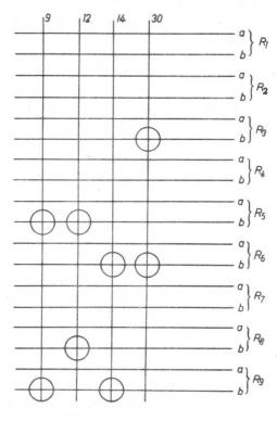
Abb. 48. Schaltung der Germaniumdioden (durch kleine Kreise dargestellt) für vier Gewinnmöglichkeiten. Beschreibung siehe im Text.
