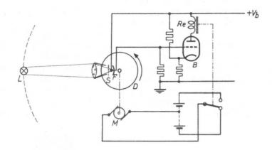
Abb. 7. Prinzipschaltung einer Anordnung, die einer Lichtquelle folgen kann. Infolge der Zwischenschaltung der Blende S steuert die auf der Drehscheibe D angebrachte Fotozelle F die Relaisröhre B und damit den Motor M derart, dass die Drehscheibe der Lampe L folgt, wenn sie sich auf dem gestrichelten Kreisbogen um die Scheibe bewegt.
