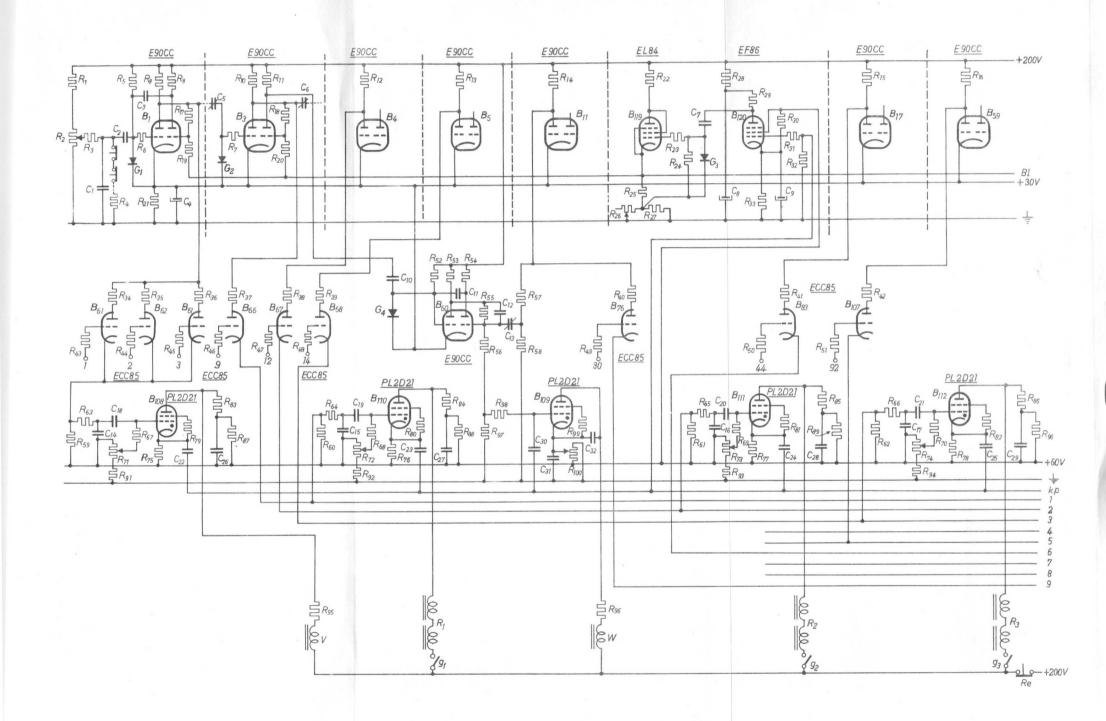
Abb. 42 für eines der neun Fächer angegeben ist. Aus dieser Abb. geht hervor, dass Relais  $G_1$  beim Drücken der Taste 1 nur eingeschaltet wird, wenn das Relais  $R_1$  nicht bereits angezogen ist. Relais  $G_1$  bleibt dann durch den Selbsthaltekontakt (den untersten in der Reihe) angezogen. Mit demselben Kontakt wird gleichzeitig die Anodenspannung für das Thyratron unterbrochen, so dass Relais  $R_1$  nicht mehr anziehen kann.
