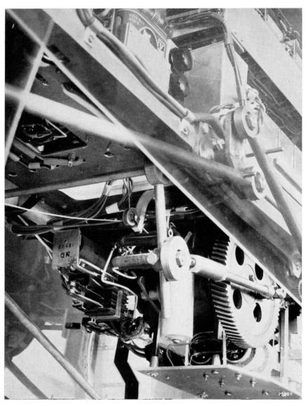
Unteransicht des Robotertieres mit deutlich sichtbarem Antriebsmechanismus der Beine. Das sichtbare Relais betätigt den Antriebsmotor, der übrigens nicht deutlich zu erkennen ist. Die beiden kleinen runden Motoren unten auf der Abbildung bilden zusammen den Steuermotor.
