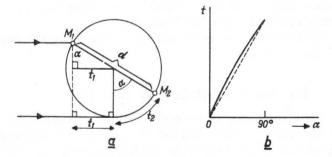
Abb. 13. Der Phasenunterschied  $t = (t_1 + t_2)$  in Abhängigkeit vom Winkel  $\alpha$ , unter dem der Schall von 2 Mikrofonen  $M_1$  und  $M_2$ , aufgefangen wird, die sich an einem zylindrischen Kopf befinden. Das Verhältnis ist unter a grafisch dargestellt und zeigt sich als angenähert linear (vergl. die rechte gestrichelte Linie).
