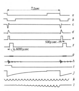
Abb. 28. Beziehungen zwischenden verschiedenen Signalen in der akustischen Radaranlage.
