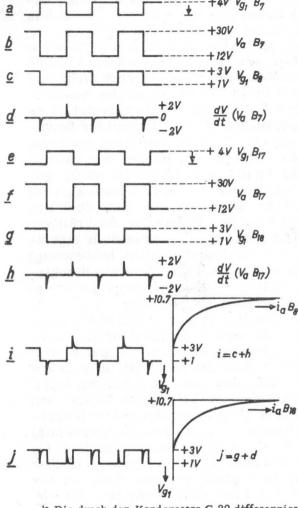
Abb. 20. Zusammenhang zwischen den Gitter- und Anodenspannungen im Phasenindikator aus Abb. 19.
