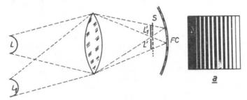
Abb. 6. Die Blende S bewirkt, dass bei seitlicher Verschiebung der Lichtquelle L mehr oder weniger Licht auf die Katode F fällt. a. zeigt den Aufbau der Blende S.
