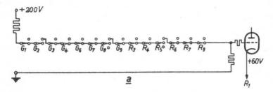
Abb. 44. a. Schaltung des Gitterkreises einer Torstufenröhre für einen Gegenzug des Apparates auf Feld 1. Nur wenn alle Kontakte geschlossen sind, kann die Antwort von dieser Torstufe gegeben werden.
