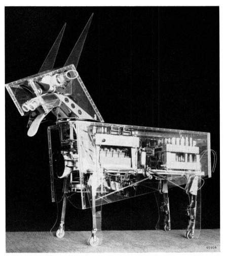
Gesamtansicht. Durch die provisorische Plastikhaut erkennt man in dem Rumpf links oben das "Gehirn"-Chassis, darunter den Speiseakku, rechts oben das Chassis für den "stereoskopischen" und stereophonischen Teil, darunter das Radarchassis. Zwischen diesen Chassis ist der Zerhackerteil der Speisung noch sichtbar. Das Hebelsystem, das die Beine in Bewegung setzt, ist auf dieser Abbildung deutlich zu sehen.
