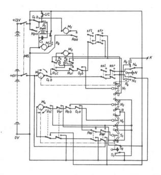
Abb. 30. Steuerung der Motoren (M) des Roboters über Relais- und Schleifkontakte.
