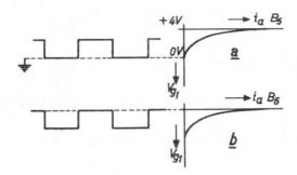
Abb. 17. Die Rechteckspannung bildet sich wegen der Germaniumdiode G5 im Gitterkreis der Röhre B5 aus, wie unter a wiedergegeben. Die gleiche Rechteckspannung stellt sich durch den der Röhre B6 auftretenden Gitterstrom ein, wie unter b wiedergegeben.
