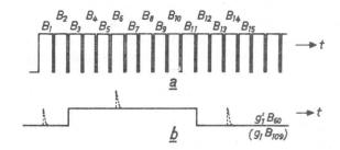
Abb. 49. Zeitverhältnis zwischen den Impulsen der Kettenschaltung (a) und der Torstufenröhre B<sub>60</sub> für die Gewinnstufe (b). Die Impulse, die an der Katodenimpulsleitung auftreten können, sind gestrichelt dargestellt. Nur während der Dauer des Rechteckimpulses kann ein Katodenimpuls das Thyratron B<sub>109</sub> (Abb. 43) zum zünden bringen.
