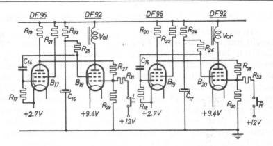
Abb. 24. Die Stufe für das Tastgefühlt (linke bzw. rechte Seite), gesteuert von den Schaltern L bzw. R.
