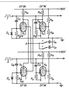
Abb. 16. Schaltbild des Phasenmessers. Die Spannung an Punkt A ist linear von dem Phasenunterschied zwischen den Eingangsignalen 1 und 2 abhangig.
