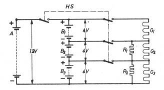
Abb. 37. Anschluss der Heizkreise an den 12V-Akku unter Verwendung von drei Trockenbatterien von je 4V. HS = 4-poliger Heizstromschalter. Beschreibung s. Text.
