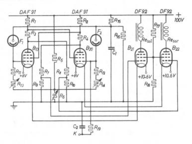
Abb. 8. Vollständige "stereoskopische" Fotozellenschaltung für Batterieröhren. Wenn Fotozelle  $F_1$  mehr Licht erhält als  $F_2$ , wird das Relais  $Re_{SS1}$  betätigt; erhält  $F_1$  weniger Licht als  $F_2$ , dann zieht Relais  $Re_{SST}$  an. Bei richtiger Einstellung von  $R_6$  ist ohne Licht stets eines der beiden Relais angezogen. s. auch Abb. 9.
