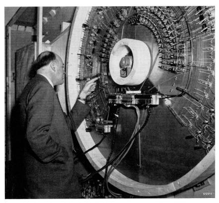
Rückseite des NK-Spiels. Rückseite des stationären Robosers. Man erkennt einen Teil der Verdrahtung des kreisförmigen elektronischen Teiles. Die Verbindungen des Speiseteils (unten im Schrank) mit dem Spielfeld laufen über mehrpolige Stecker, um das Ganze leicht demontierbar zu machen.
