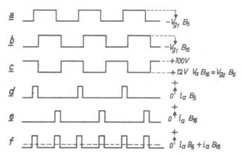
Abb. 18. Beziehungen zwischen den zugeleiteten Rechteckspannungen bei einem bestimmten Phasenunterschied (+ 45°), und den Anoden- und Schirmgitterspannungen und Anodenströmen der Phasenmessers aus Abb. 16.
