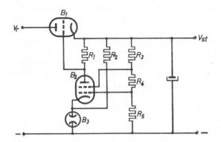
Abb. 38. Prinzip einer gebräuchlichen Schaltung für Stabilisierung der Ausgangsspannung Vst.
