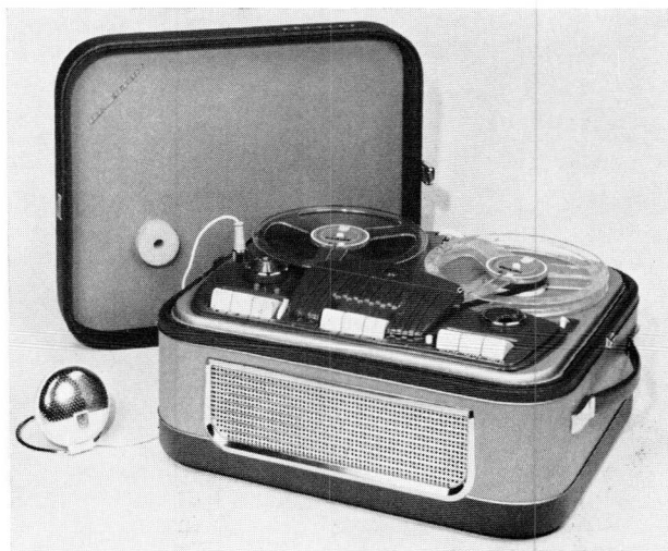
Foto 11. Recorder uit de middelste prijsklasse met 3 bandsnelheden: 4,75-9,5 en 19 cm/sec. Drukknopbediening, 18 cm spoelen, 4 sporen techniek.
