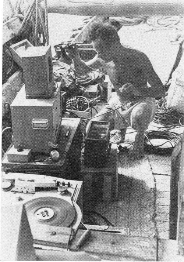
Foto 7. Op een boot opgestelde magnetische recorder voor het registreren van geluiden van tropische zeevissen.
