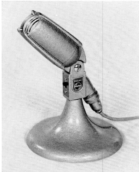
Foto 21. Elektrodynamische microfoon voor het maken van stereofonische opnamen. Deze microfoon is samengesteld uit twee super-cardioïde systemen.
