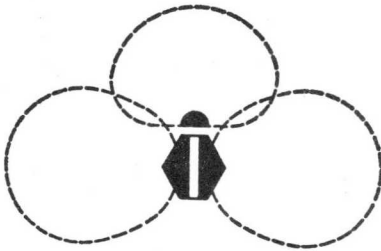
Fig. 149. Stereofonische microfoon, bestaande uit een combinatie van een microfoon met acht-vormige karakteristiek en een microfoon met eenzijdige gevoeligheid, voor professionele toepassingen.
