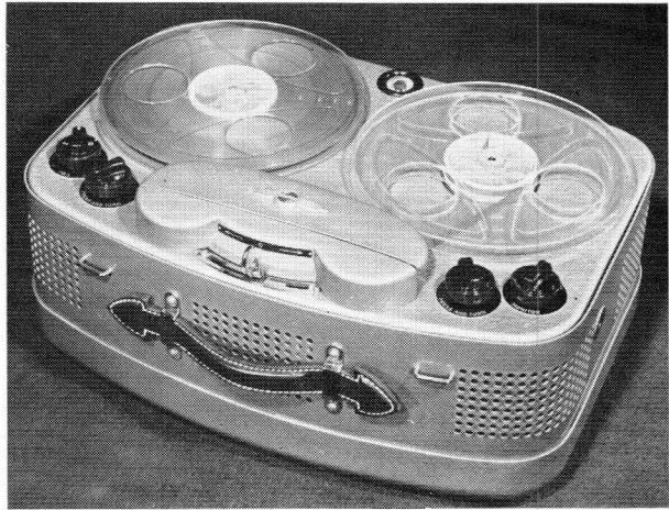
Foto 26. Eenvoudige draagbare professionele recorder met een bandsnelheid van 19 cm/s, voorzien van drie magneetkoppen.
