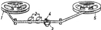
Fig. 60. Onderdelen van een recorder die invloed kunnen uitoefenen op een regelmatig bandtransport. 1. Aflopende spoel. 2. Wis- en opneemknoppen. 3. Rubber aandrukrol. 4. Toonas. 5. Opwikkelspoel (vaak komen hier nog bandgeleidenden bij).
