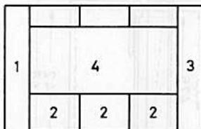
Eine Einheit besteht aus je einem linken und rechten Seitenstück (1 und 3) und einer bestimmten Anzahl Röhrenhalterungen (2), die zur Aufnahme einer Filterplatte (4) vorgesehen sind.
