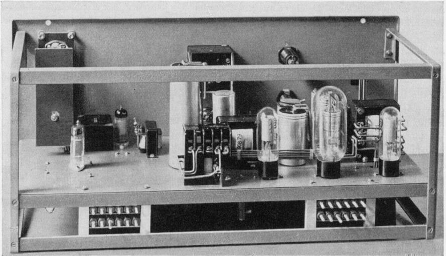
Abb. 4-32. Chassisaufbau eines Metallsuchgerätes (Typ TA 2 von G. Ziegler, Frankfurt a.M.)
