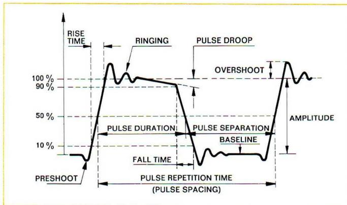
Fig. 4.1. Pulse parameters
