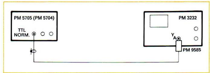
Fig. 4.10. Test set-up
