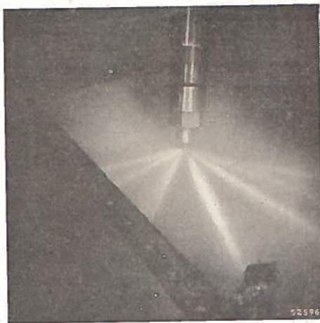
Fig. 13. Contrôle van een brandstof-inspuiting.
