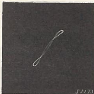
Fig. 4. Vervorming van het oscillogram door niet sinusvormige afbuigspanningen. Een dergelijk oscillogram kan men verwachten bij het meten van spoelen met gesloten ijzern kern, als de inductie in het ijzer niet zeer laag is.
