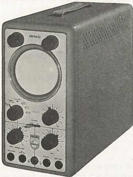
Fig. 1. Vooraanzicht van de oscillograaf GM 5655. De kleine afmetingen blijken duidelijk uit de verhouding tussen de schermdiameter, welke 7 cm bedraagt, en de breedte en hoogte van de kast.
