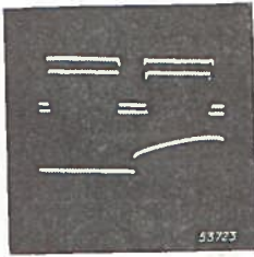
Fig. 17. Oscillogrammen van de stromen door de primaire en secundaire contacten en door de bekrachtigingsspoel van een triller. Van boven naar beneden: de stromen door de primaire contacten, de stromen door de secundaire contacten, de nullijnen van de primaire en van de secundaire stroom, de stroom door de bekrachtigingsspoel (rechts), en de nullijn van deze stroom (links).
