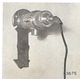
Fig. 4. Speciale trillingsopnemer GM 5520, aan de muur geklemd.
