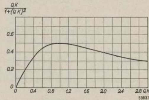
Fig. 13. Le terme \frac{QK}{1 + Q^2 K^2} de l'équation (I B 16) en fonction de QK
