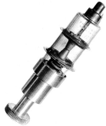
A la réception (bas niveau d'énergie), la décharge ne se produit pas et le tube ne provoque qu'une atténuation faible sur l'écho se dirigeant vers l'antenne.
