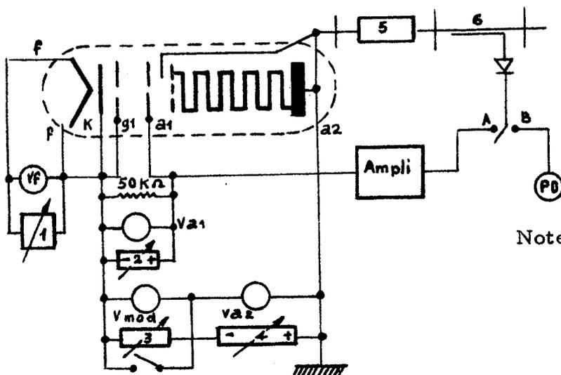
1. - Alimentation filament 6,3 V, stabilisée à 5,10-2
